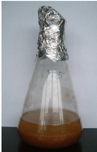
รูปที่ 4 โปรตีนปลาที่ผสมกับกรดไฮโดรคลอริก (ก่อนย่อย) สัดส่วนโปรตีนปลาต่อกรด 1:5
