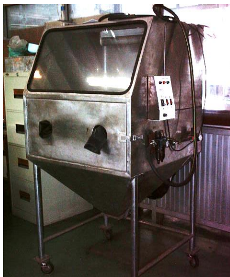
รูปที่ ๓.๕ แสดงชุดทดสอบเครื่องพ่นทราย (Sand Ejection Machine)
