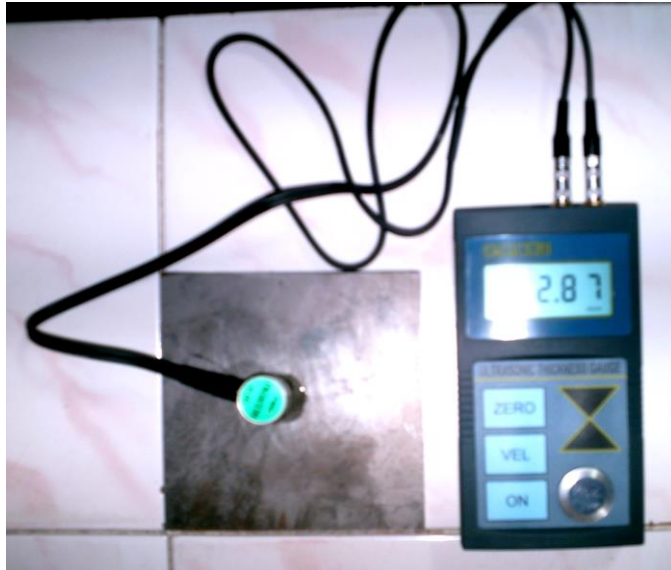
รูปที่ ๓.๖ เครื่องทดสอบวัดความหนาของโลหะด้วยคลื่นอัลตราโซนิก (Ultrasonic Thickness Measurement)
