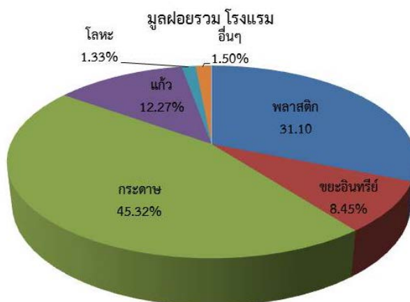
ภาพที่ 4.28 องค์ประกอบของขยะมูลฝอยรวมของโรงแรม
