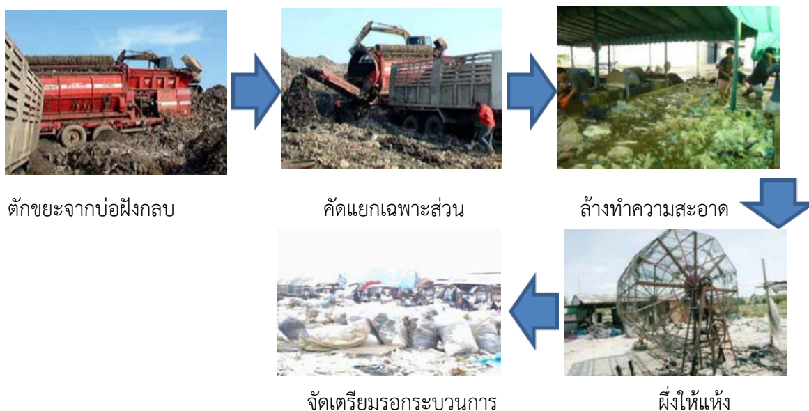
ภาพที่ 2.2 แผนผังกระบวนการจัดเตรียมวัตถุดิบเพื่อรีไซเคิลพลาสติกเป็นน้ำมัน
