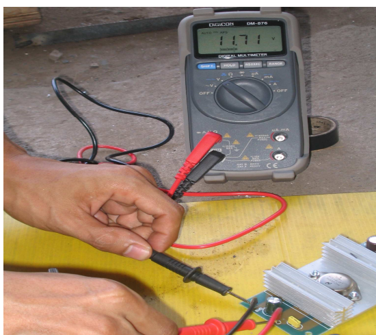
ภาพที่ 36 แสดงการใช้ดิจิตอลมัลติมิเตอร์วัดค่าแรงดัน
