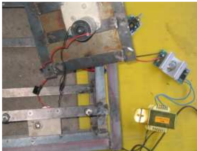
ภาพที่ 39 แสดงตำแหน่งการยึดมอเตอร์โดยมองจากด้านบน
