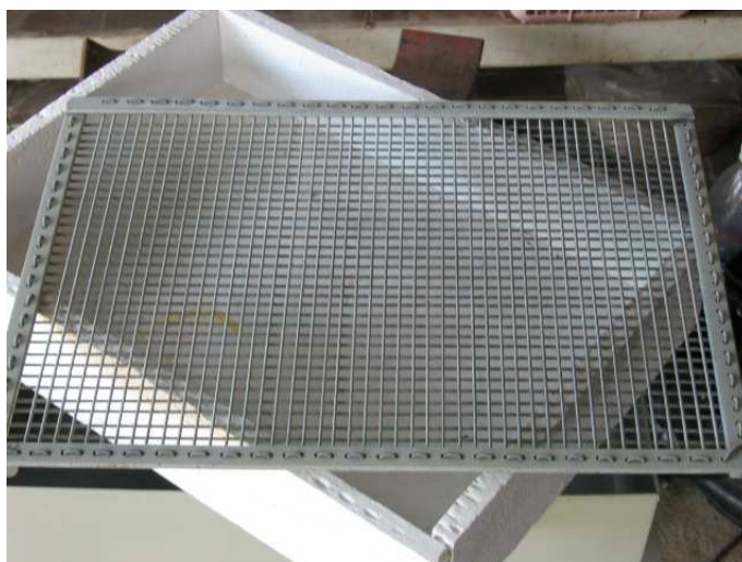
ภาพที่ 49 แสดงการใช้สปริงทำสายรัดภาชนะทดลอง
