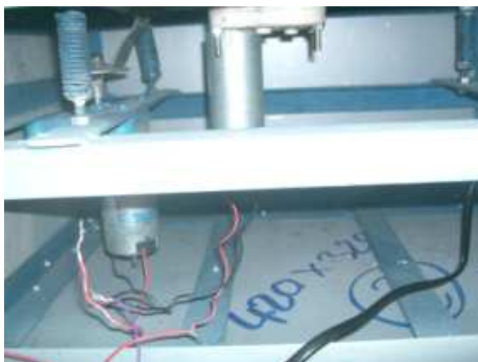
ภาพที่ 40 แสดงตำแหน่งการยึดมอเตอร์โดยมองจากด้านล่าง
