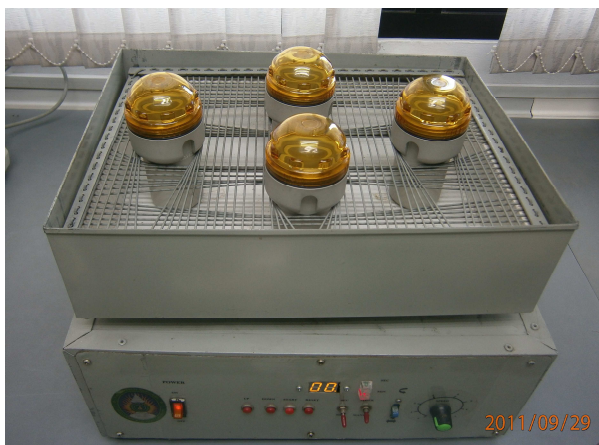
ภาพที่ 31 เครื่องเขย่าสารเคมีที่พัฒนาขึ้นใหม่ที่กำลังเขย่าสารตัวอย่าง
