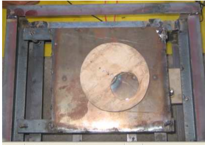
ภาพที่ 38 แสดงการทำโครงสร้างของเครื่องเขย่าสาร
