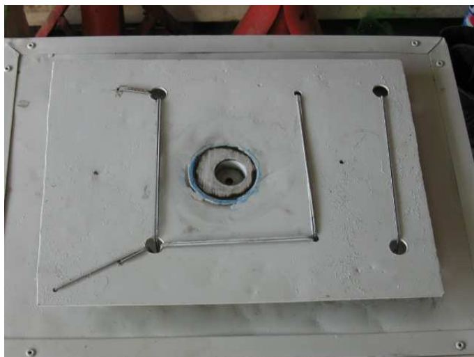
ภาพที่ 42 แสดงการใช้เพลลาข้อเหวี่ยงชุดเคลื่อนที่วงกลม
