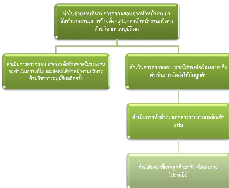
ภาพที่ 4.15 กระบวนการจัดทำรายงานผลการทดสอบ
