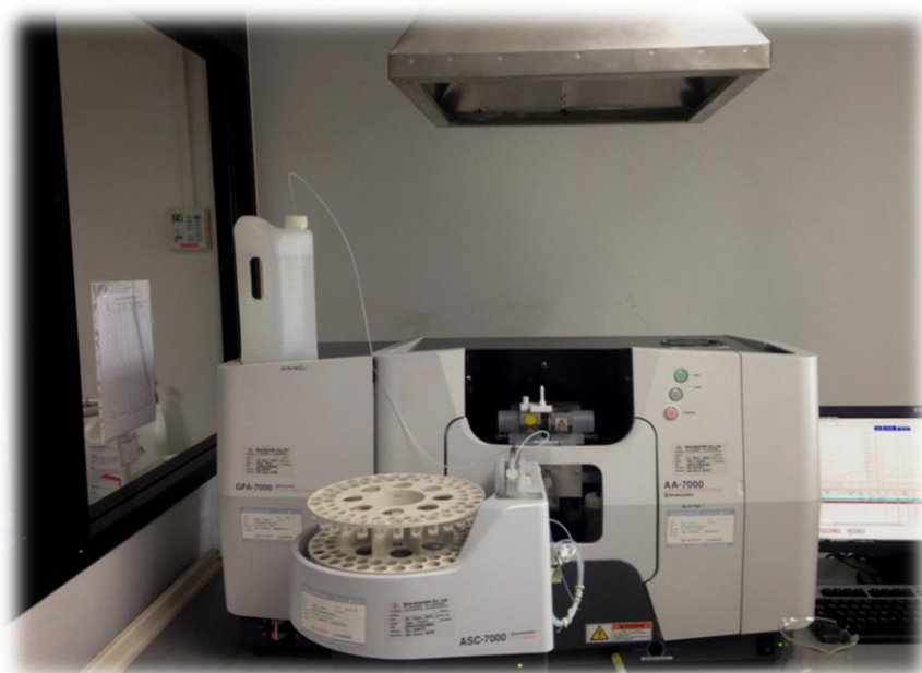
ภาพที่ ก-15 เครื่อง Atomic Absorption (AA)ใช้ในการวิเคราะห์โลหะหนัก
