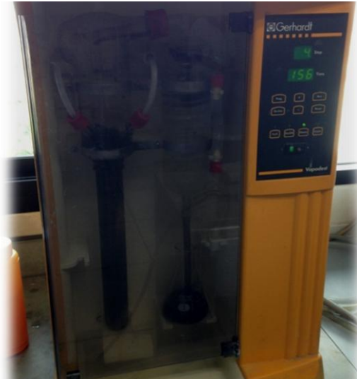
ภาพที่ก-13 การวิเคราะห์หาปริมาณไนโตรเจนทั้งหมดโดยวิธีเจลดาคาร์ล (Kjeldahl Method)
