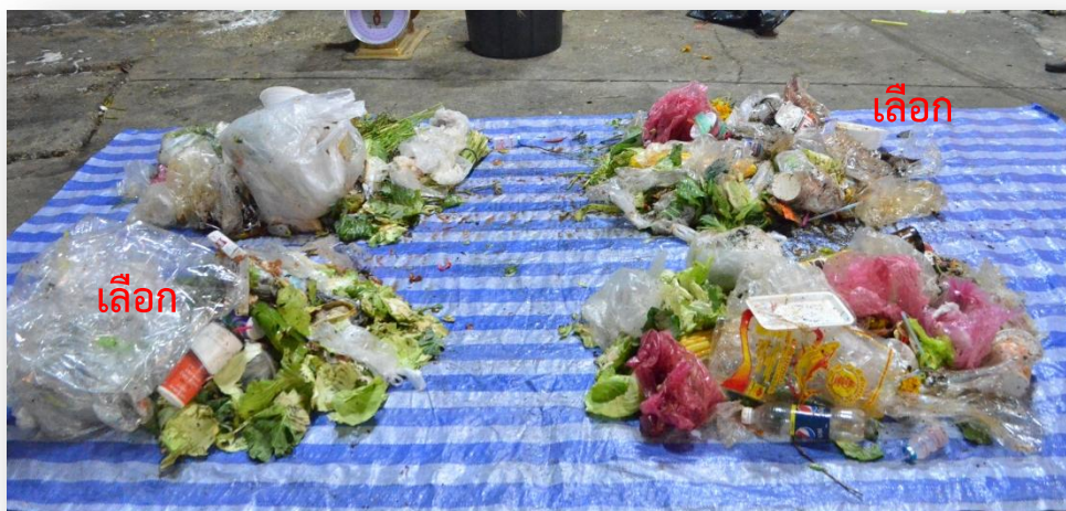
ภาพที่ 3.2 การแบ่งขยะออกเป็น 4 ส่วน (Quartering) และเลือกสุ่มเอามา 2 ส่วนที่อยู่ตรงข้ามกัน
