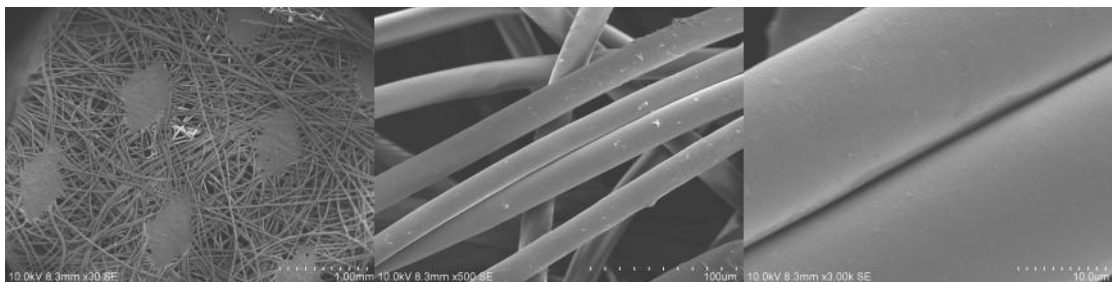
ภาพที่ 4.1 แสดงภาพ SEM ของเส้นใยพอลิโพรพิลีนก่อนการอาบพลาสมา ที่กำลังขยาย (ก) 30 เท่า (ข) 500 เท่า และ (ค) 3000 เท่า ตามลำดับ
