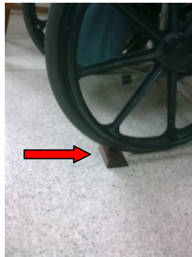
อุปกรณ์ช่วยล็อกล้อของล้อเข็นทำเป็นลิ่ม กรณีล้อกไม่อยู่หรือขณะทำกิจกรรมต่างๆ
