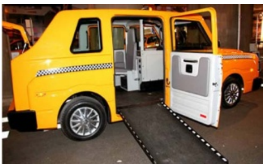
ทางลาดสำหรับล้อเข็นที่นำมาปรับใช้กับรถยนต์
