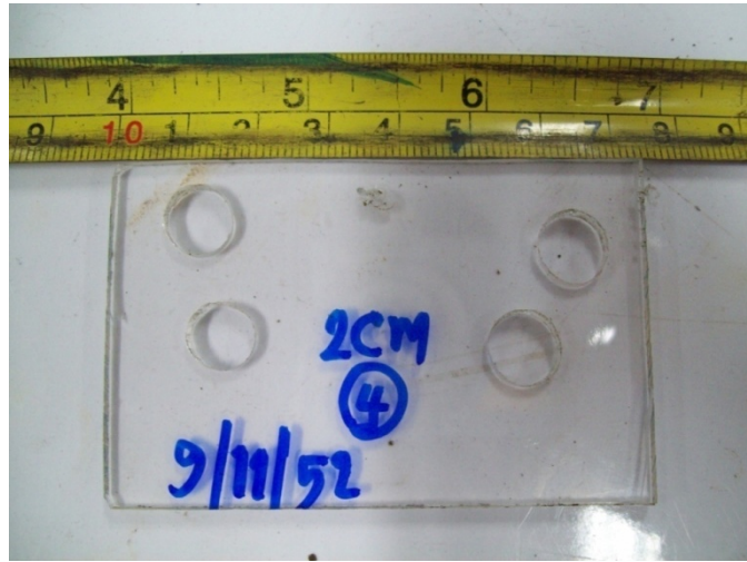
รูปที่ ค.4 รอยเสียหายจากการยิงในอากาศ ที่ระยะห่างจากหัวฉีด 20 mm ครั้งที่ 2
