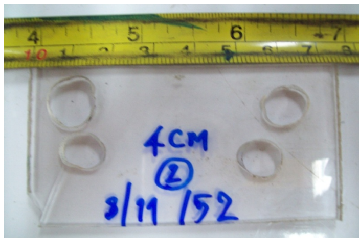
รูปที่ ค.9 รอยเสียหายจากการยิงในอากาศ ที่ระยะห่างจากหัวฉีด 40 mm ครั้งที่ 2
