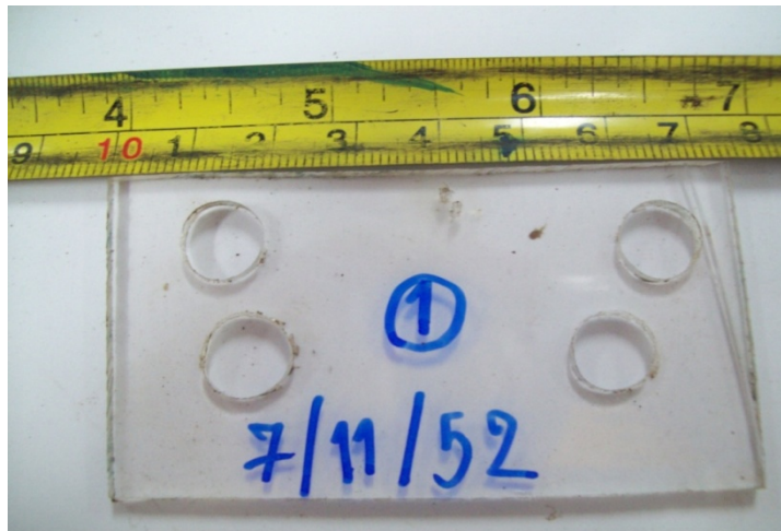
รูปที่ ค.8 รอยเสียหายจากการยิงในอากาศ ที่ระยะห่างจากหัวฉีด 40 mm ครั้งที่ 1
