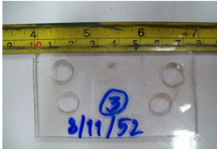
รูปที่ ค.7 รอยเสียหายจากการยิงในอากาศแบบ ที่ระยะห่างจากหัวฉีด 30 mm ครั้งที่ 2
