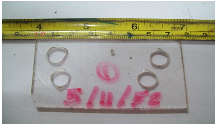
รูปที่ ค.10 รอยเสียหายจากการยิงในอากาศ ที่ระยะห่างจากหัวฉีด 50 mm ครั้งที่ 1
