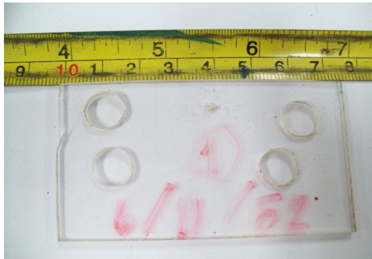
รูปที่ ค.11 รอยเสียหายจากการยิงในอากาศ ที่ระยะห่างจากหัวฉีด 50 mm ครั้งที่ 2
