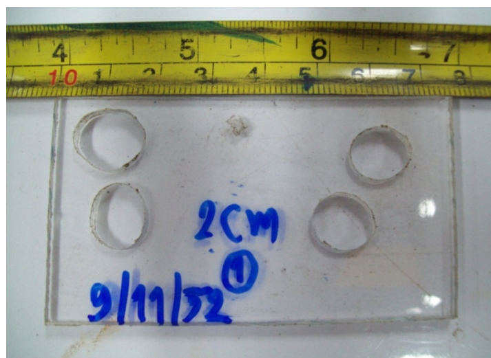
รูปที่ ค.3 รอยเสียหายจากการยิงในอากาศ ที่ระยะห่างจากหัวฉีด 20 mm ครั้งที่ 1
