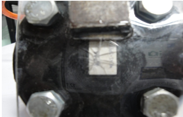
รูปที่ ค.13 รอยเสียหายจากการยิงในน้ำ ที่ระยะห่างจากหัวฉีด 30 mm ครั้งที่ 2
