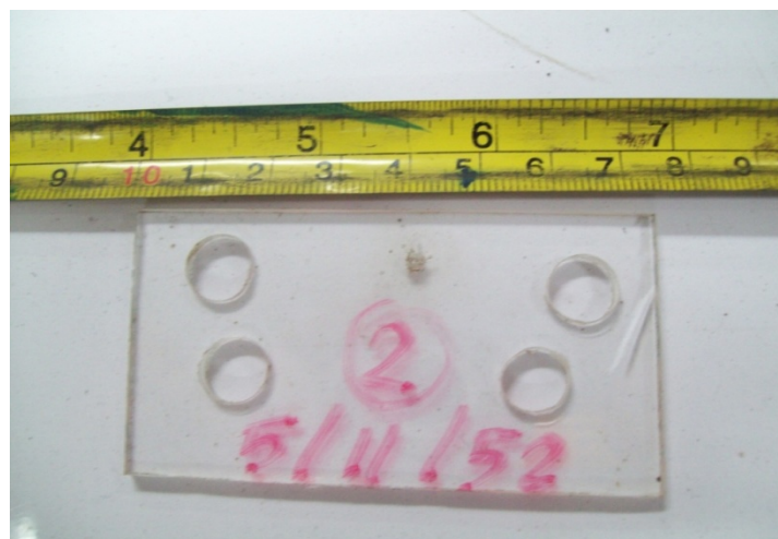
รูปที่ ค.12 รอยเสียหายจากการยิงในอากาศ ที่ระยะห่างจากหัวฉีด 50 mm ครั้งที่ 3
