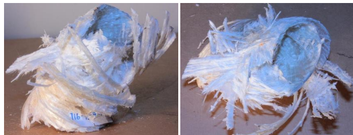
รูปที่ 5 การเสียหายสุดท้ายของโครงสร้างที่เสียหายของชั้นงาน [+45/-45]_3
