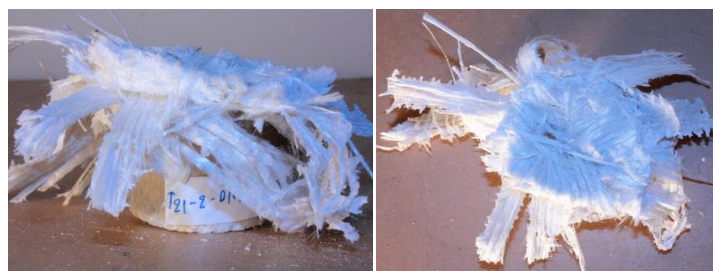
รูปที่ 7 การเสียหายสุดท้ายของโครงสร้างที่เสียหายของชั้นงาน [+45/-45]/[0/90]/[+45/-45]
