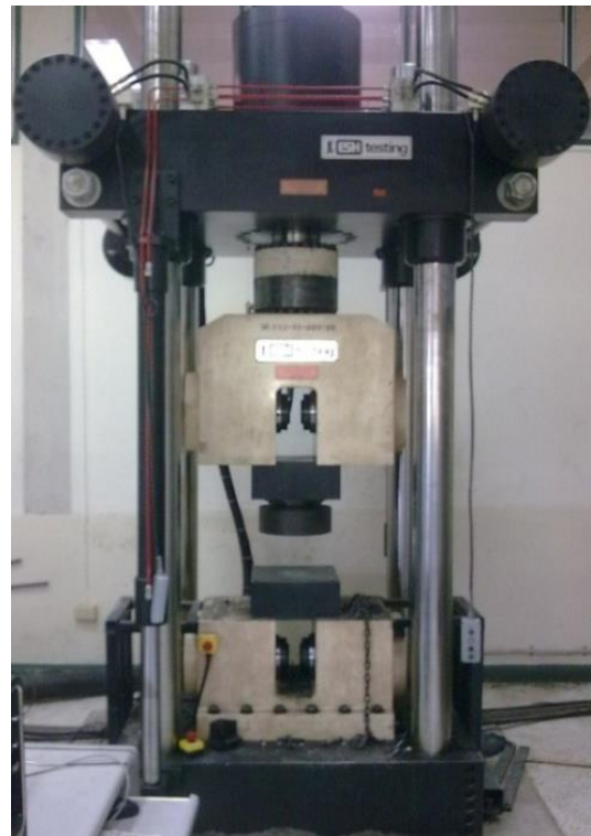
รูปที่ 5 เครื่องทดสอบการกดแบบแรงกระทำกึ่งคงที่
