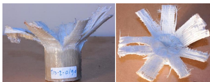
รูปที่ 6 การเสียหายสุดท้ายของโครงสร้างที่เสียหายของชั้นงาน [0/90]_3
