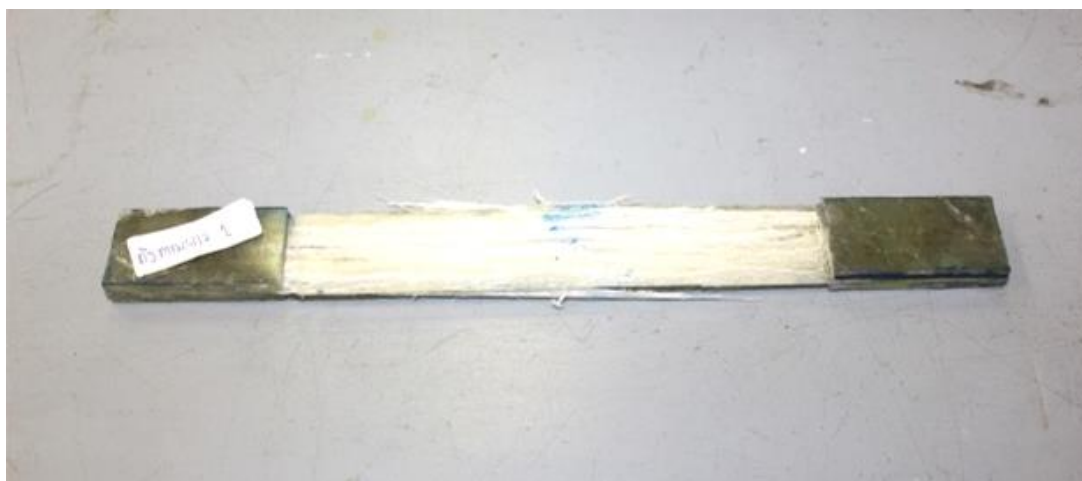
ภาพที่ 3.29 ชิ้นงานที่มีการเรียงตัวของเส้นใยทิศทางเดียว สำหรับการทดลองแรงดึง
