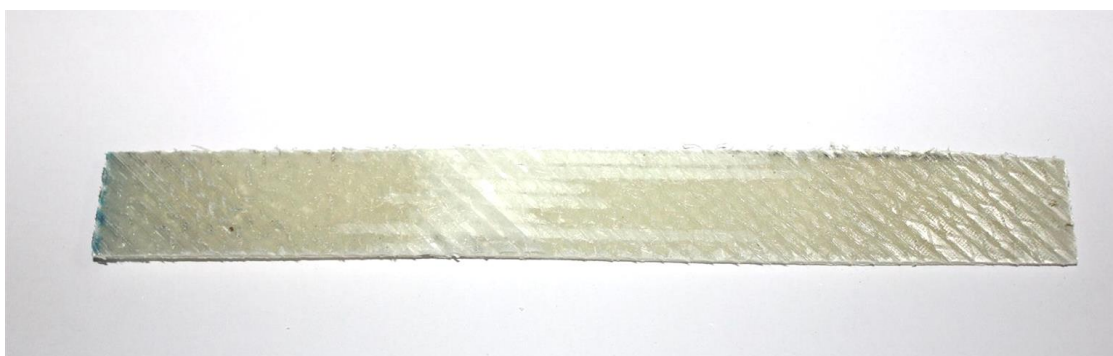
ภาพที่ 3.27 ชิ้นงาน C ที่มีการเรียงตัวของเส้นใยคือ [45/-45]/ [0/90]/ [45/-45] สำหรับการทดลองแรงดึง
