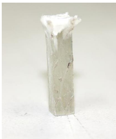
ภาพที่ 3.42 ชิ้นงานที่มีการเรียงตัวของเส้นใยตามแนวยาวของชิ้นงาน สำหรับการทดลองแรงกด
