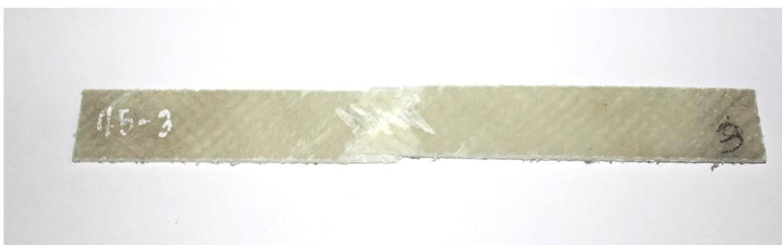
ภาพที่ 3.25 ชิ้นงาน B ที่มีการเรียงตัวของเส้นใยคือ [(45/-45)/(45/-45)/(45/-45)] สำหรับการทดลองแรงดึง
