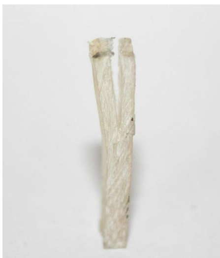
ภาพที่ 3.46 ชิ้นงานที่มีการเรียงตัวของเส้นใยตามแนวขวางของชิ้นงานสำหรับการทดลองแรงกด
