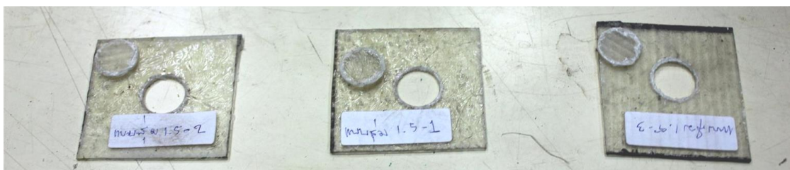
ภาพที่ 3.51 ชิ้นงานที่มีการเรียงตัวของเส้นใยแบบสุ่มหลายทิศทางของชิ้นงานสำหรับการทดลองแรงเฉือน
