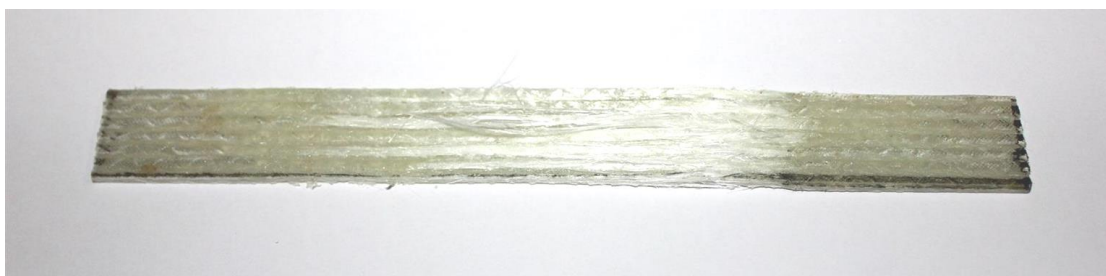
ภาพที่ 3.23 ชิ้นงาน A ที่มีการเรียงตัวของเส้นใยคือ [0/90]/ [0/90]/ [0/90] สำหรับการทดลองแรงดึง
