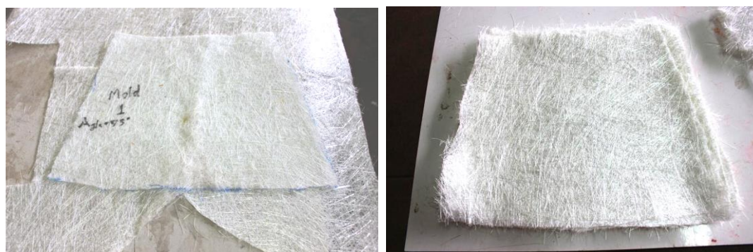
ภาพที่ 3.8 เส้นใยแก้วที่ตัดตามลักษณะของชิ้นงาน สำหรับใช้ในการขึ้นรูป
