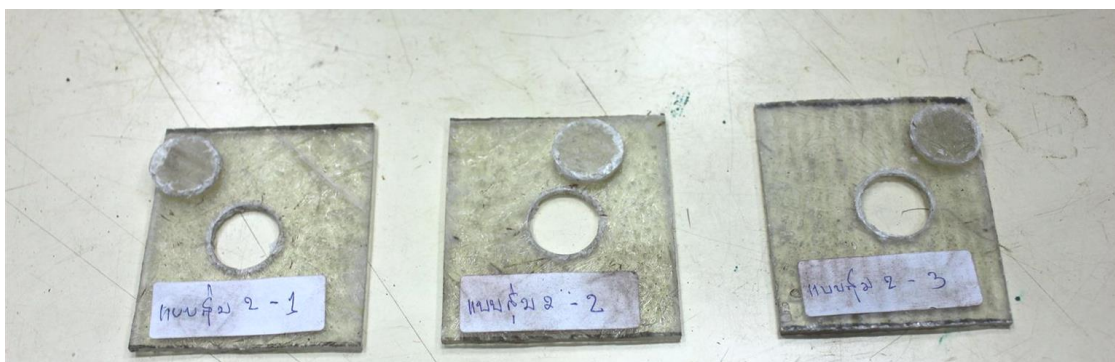
ภาพที่ 3.53 ชิ้นงานที่มีการเรียงตัวของเส้นใยแบบสุ่มหลายทิศทางของชิ้นงานสำหรับการทดลองแรงเฉือน
