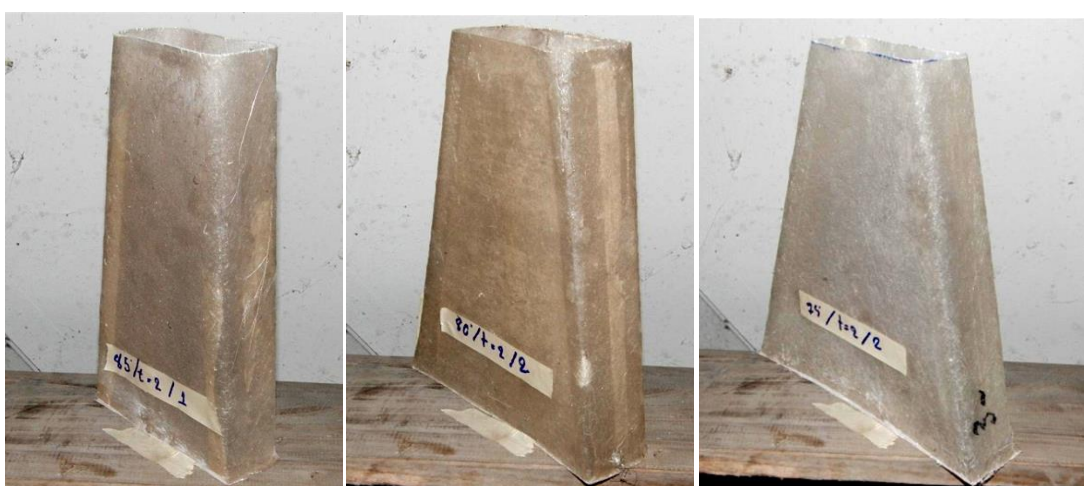
ภาพที่ 3.13 ชิ้นงานที่ใช้ในการทดสอบ (ก) ชิ้นงาน ที่มีมุมเอียง 5 องศา (ข) ชิ้นงาน ที่มีมุมเอียง 10 องศา และ(ค) ชิ้นงาน ที่มีมุมเอียง 15 องศา
