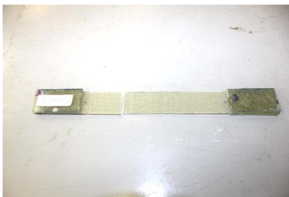
ภาพที่ 3.31 ชิ้นงานที่มีการเรียงตัวของเส้นใยทิศทางเดียว สำหรับการทดลองแรงดึง
