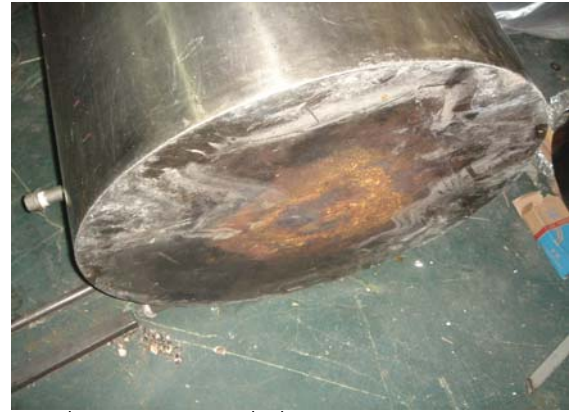
ภาพที่ 1 ด้านล่างของถังกลั่นที่สัมผัสเปลวไฟจะสึกหรือเร็วมาก
