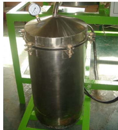
ภาพที่ 2 หม้อกำเนิดไอน้ำขนาดเล็ก
