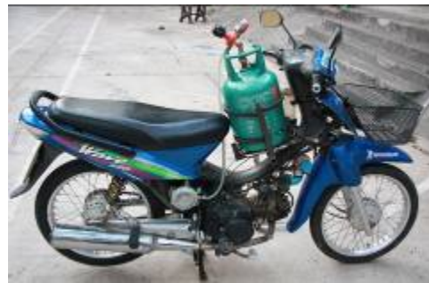
รูปที่ 8 ต้นแบบรถจักรยานยนต์พลังงานก๊าซชีวภาพ
