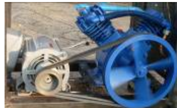
รูปที่ 2 เครื่องอัดก๊าซชีวภาพและมอเตอร์ต้นกำลัง
