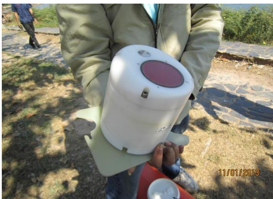
รูปที่ 5.1 เครื่องมือวัดความลึกและความเร็วการสำหรับรูปตัดลำน้ำในภาคสนาม
