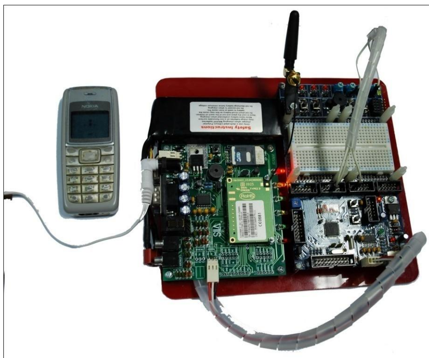
รูปที่ 3.5 การทดสอบการทำงานของตัวประมวลผลและตัวรับส่งข้อมูล
